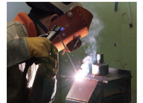
# 被覆アーク溶接
